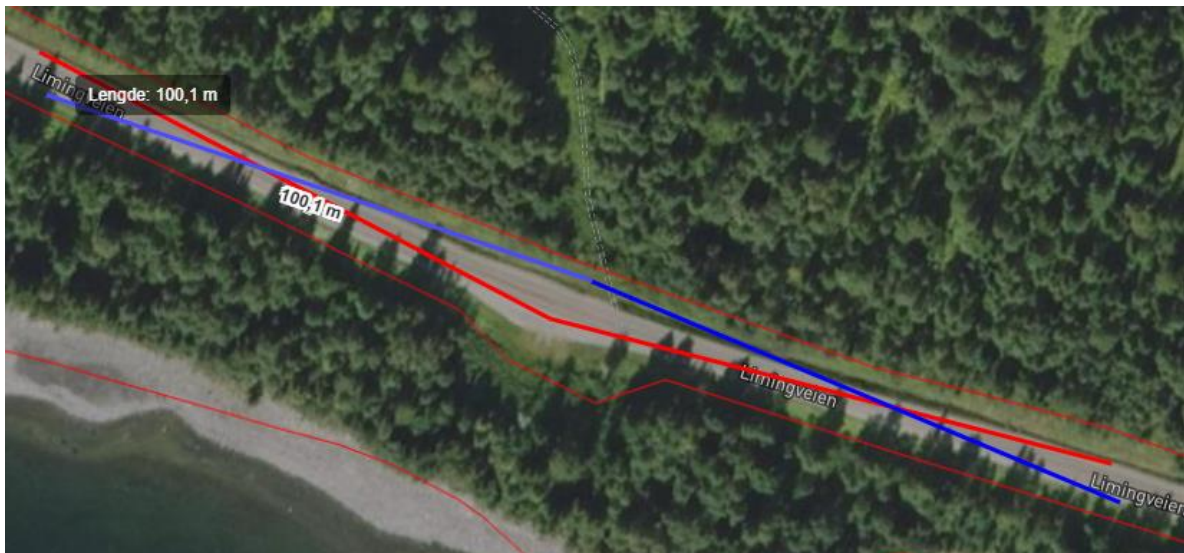
Figur 7. Frisiktlinjer fra den østre avkjøringen, og parkeringslomma/møteplassen.
