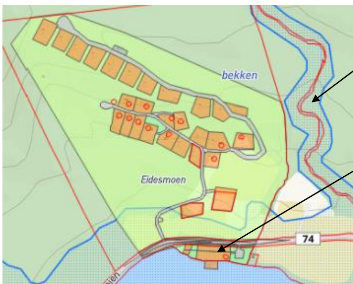
Figur 2. Viser aktsomhetsområde for flom. Aktsomhetsområdet langs rennende vann ligger øst for planområdet. I den delen som berører planområdet ligger det kun bygninger med funksjon i tilknytning til vann (naustområde).
